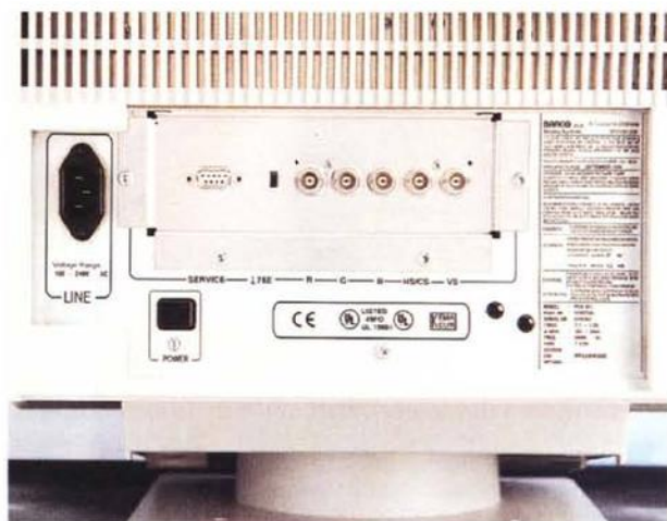
Il collegamento monitor-computer è a doppio "filo". Un cavo per il segnale video, uno per la porta seriale del "computer colore".
